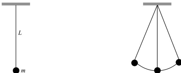
**Figura 1.** Para construir el péndulo sólo se necesita un hilo y una esfera relativamente pequeña.
